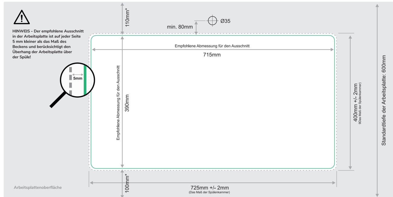
\* Annahme der Maße für eine 600 mm breite Tischplatte unter der Annahme von Standardmaßen der Schränke und eines 20 mm Überhangs der Arbeitsplatte über den Schränken. Für alle anderen Maße muss die Abmessung in der Spüle durchgeführt werden. Der Hersteller nimmt keine Gewähr für das fehlerhafte Ausschneiden der Löcher in der Arbeitsplatte.
